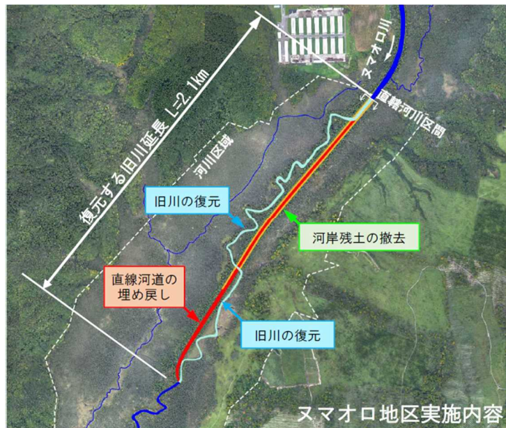
図表 3-2-10 ヌマオロ地区旧川復元工事実施内容
