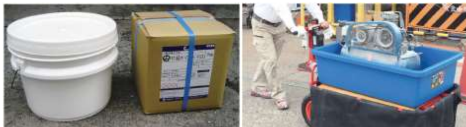
図表 2-1-22 軽量の容器とアシスト付き電動台車
